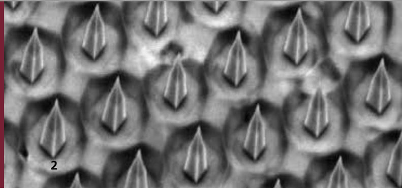
1 Einkristalliner Diamant, hergestellt mittels CVD Technologie.
